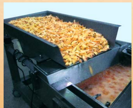
Dosiereinrichtung in Betrieb / Dispenser in operation / Dispositif de dosage en fonctionnement
